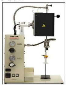
水泥或者泥浆倒入失水筒后,可编程温度控制器自动将浆体温度加热至实验温度,然后转入失水实验,仪器面板上配有正压与回压调节阀,可以将正压与回压调节到实验压力,用量筒或者滤液搜集器用于收集滤液。
