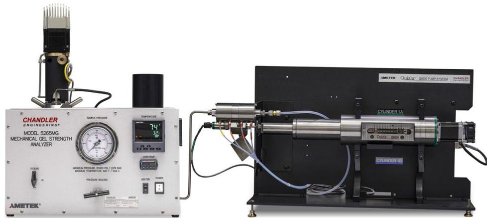
5265MGSA 测量静胶凝强度有两种可选测量方法（API 10 推荐方法）：
