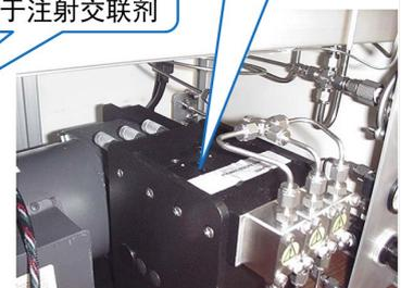
高压三缸齿轮泵用于注射基液
