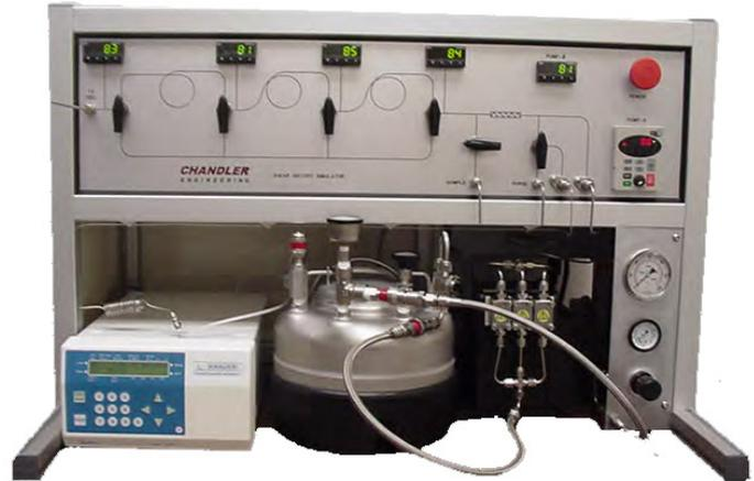
基胶（基液）注射泵是一个高压三缸泵，材料采用了耐腐蚀不锈钢，泵通过齿轮马达和频率驱动控制器驱动，排量 0-100 毫升/分钟，最大压力 5000PSI
