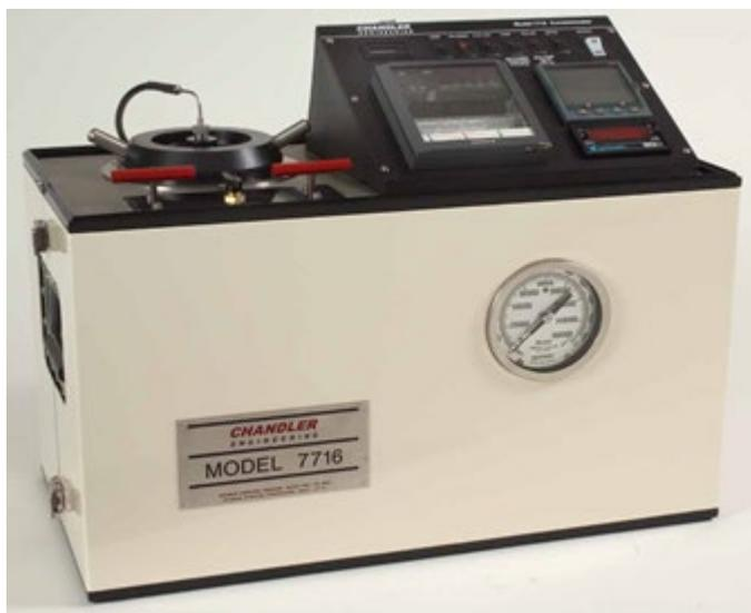
7716 型便携式稠化仪采用可编程温度控制器（非触摸屏）控制实验压力，具有多段控制温度能力；可精密控制实验温度。
