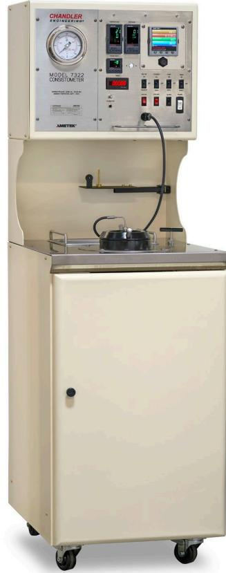
7322型高温高压稠化仪操作简单,加热以及冷却开关配有发光管,开,关状态一目了然。仪器面板上只有1个手动泄压阀以及1个压缩空气调压阀,其余全部为电动开关控制,仪器绝大多数操作可由计算机软件完成。
