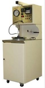
8340型高温高压稠化仪操作简单,加热以及冷却开关配有发光管, 开、关状态一目了然。仪器面板上只有1个手动泄压阀以及1个压缩空气调压阀, 其余全部为电动开关控制, 仪器绝大多数操作可由计算机软件完成。
